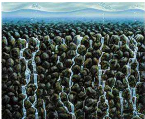
(Kanalbildung bei Granulat oder Pulver - schematische Darstellung - )
